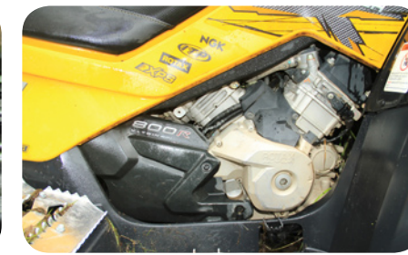
Могучий 2 — цилиндрический мотор плотно скомпонован в пространственной раме
